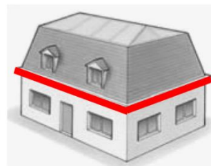
Égout du toit sur toiture à la mansarde
